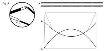
Найдите стропы с отверстиями для закрепления дуг по периметру тента (рис. В). Вставьте дуги в соответствующие отверстия в стропах.
